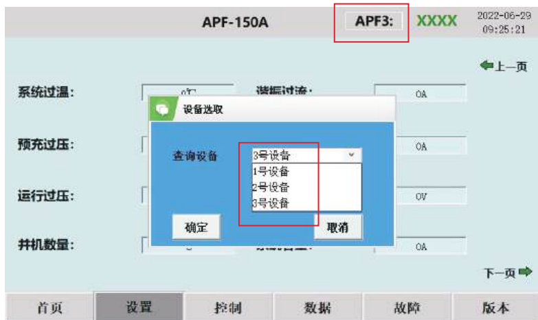
图 4-32 井机设备切换界面
